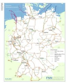
Die neue Version der VDE|FNN-Karte des deutschen Höchstspannungsnetzes dokumentiert die Fortschritte bei den Offshore-Netzanschlüssen.
