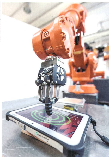
Das Robotersystem kann typische Anwendungsszenarien von Nutzern auf beliebigen Geräten tausendfach nachstellen.
