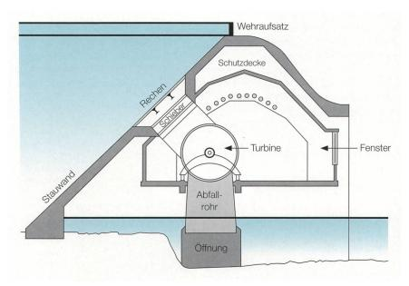
**Bild 1** Längsschnitt durch das überflutbare Kraftwerk am Patapasco River bei Baltimore, Inbetriebnahme 1907, 3 Zwillings-Francis-Turbinen à 330 kW. [3]
