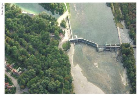
**Bild 6** Wehranlage Hochablass am Lech in Augsburg, im linken Bereich die überflutete Anlage. Inbetriebnahme 2013, 2 Maschinensätze, Ausbauleistung 3,1 MW.[11]
