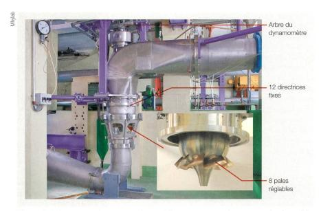
**Figure 6** Turbine Diagonale en « S » sur le stand d'essais et zoom sur la roue à 8 pales du modèle réduit d'une Diagonale.
