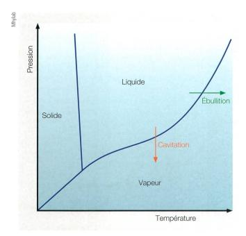
**Figure 9** Diagramme du point triple de l'eau.
