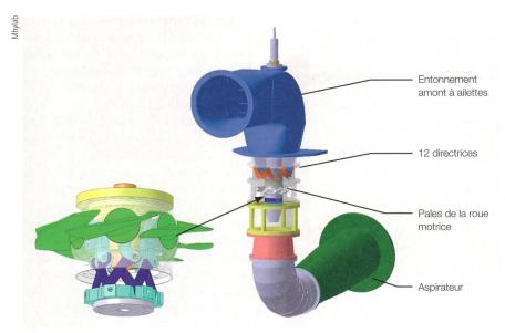
**Figure 2** Conception 3D du modèle réduit de la Kaplan en « S » à 8 pales, à simple réglage, et zoom sur la roue et ses leviers pour assurer l'ajustement de la position des pales.
