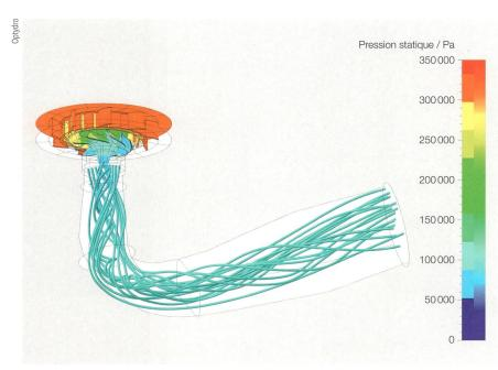
Figure 5 Simulation numérique d'une turbine Diagonale à double réglage en bâche spirale.
