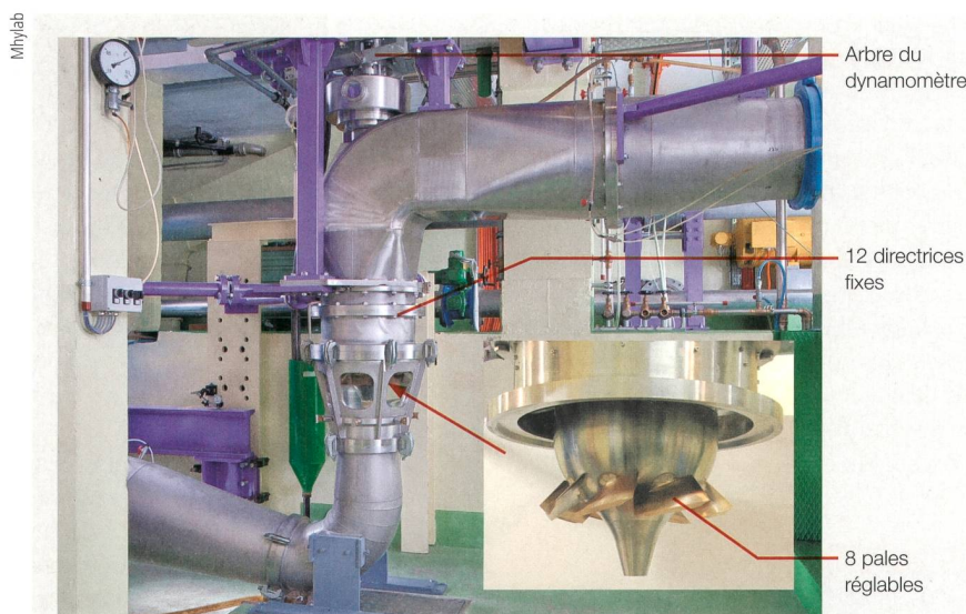
Figure 6 Turbine Diagonale en « S » sur le stand d'essais et zoom sur la roue à 8 pales du modèle réduit d'une Diagonale.
