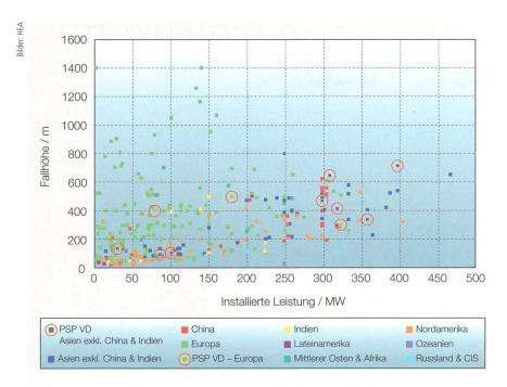
Bild 2 Weltweit installierte Pumpspeicherkraftwerke (PS VD: drehzahlvariable Anlagen).
