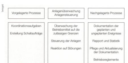
**Bild 1** Gruppierung der Netzanlagensteuerstellen-Aufgaben.
