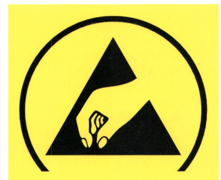
Bild 2 Symbol für ESD-Schutzkomponenten.
