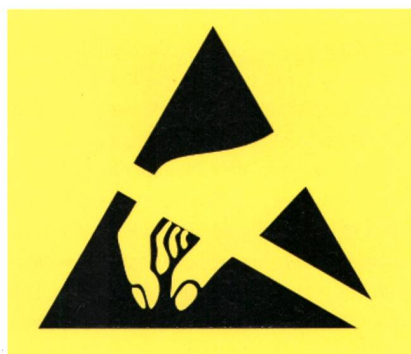
Bild 1 Symbol für ESD-gefährdete Bauteile.
