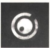
**Bild 4** Eine LED unter dem Emissionsmikroskop: Schon kleinste, durch elektrostatische Entladungen verursachte Störstellen haben auf Dauer grosse Auswirkungen, denn die Stromdichte ist da deutlich grösser als in der Umgebung und führt zu einem Ausweiten der blinden Stelle: links ist eine kleine Störstelle sichtbar, die sich im Betrieb mit der Zeit vergrössert.
