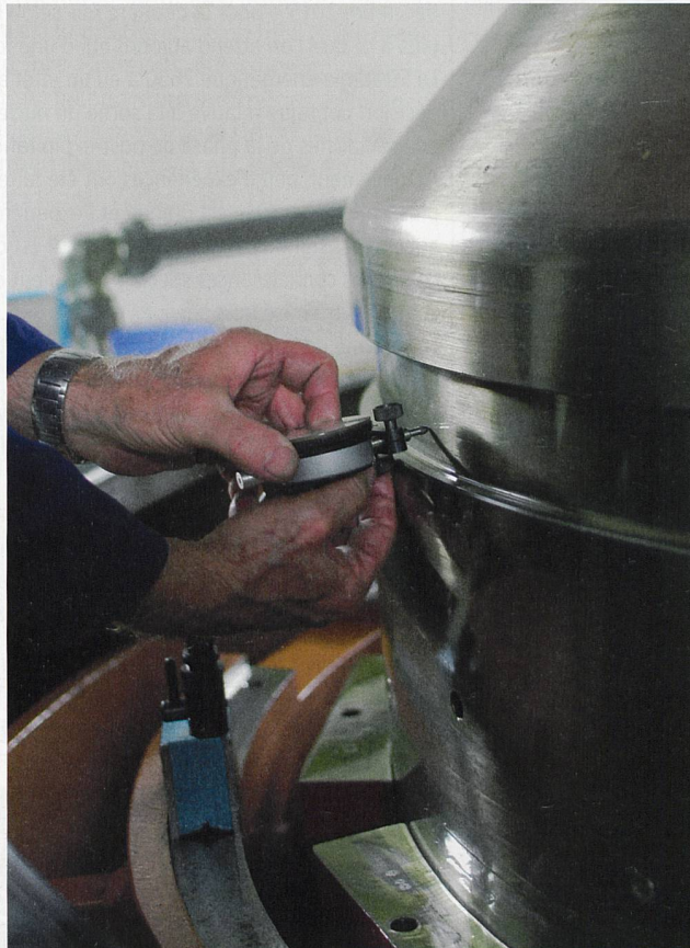
Figure 1 Inspection d'une turbine.
