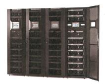
Bei der modular skalierbaren USV-Anlage Multi-Power MPW können pro Schrank sieben USV-Module zu je 42 kVA/KW installiert werden, wobei 252 kW genutzt werden und ein Modul (42 kW) als Redundanz zur Verfügung steht. Die MPW ist bis auf 1 MW plus Redundanz erweiterbar. Sie zeichnet sich durch ihre unerreichte Leistungsdichte, einem hohen Wirkungsgrad von bis zu 96,5% aus. Bereits bei einer Last von 20% erreicht sie einen Wirkungsrad von über 95%.
