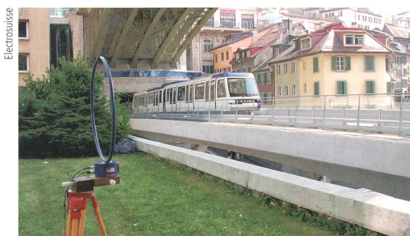
Le laboratoire de Rossens effectue également des mesures de CEM in situ, ici pour le métro de la ligne M2 à Lausanne.
