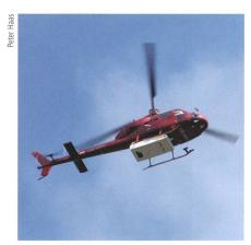
Lidar-Messung für digitales Oberflächenmodell.
