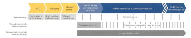
Bild 2 Massnahmen zur Qualitätssicherung während der Entwicklung, Fertigung und Lebensdauer des Betriebsmittels.
