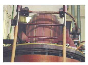
**Bild 4** Deformierter Trafokern.
