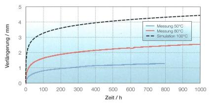
**Bild 3** Längenänderung eines 4 m langen Seils über die Zeit. Die Zugspannung beträgt 50 MPa. Gezeigt sind Messungen für die Temperaturen 50 und 80 °C. Die gestrichelte Kurve zeigt die berechnete Längenänderung bei 100 °C.
