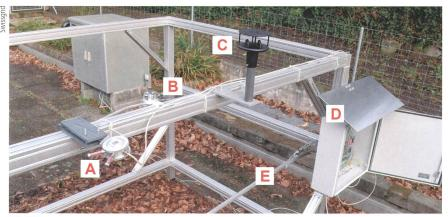
**Bild 2** Die dritte Messstelle im Freien. Verschiedene Sensoren messen das Wetter: A: Sonneneinstrahlung, B: Niederschlag, C: Wind. In der Box D befindet sich die zentrale Datenerfassung und E markiert das Leiterseil.
