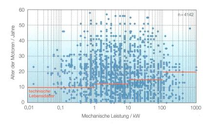
Bild 4 Verteilung der Motoren nach Alter und Grösse.
