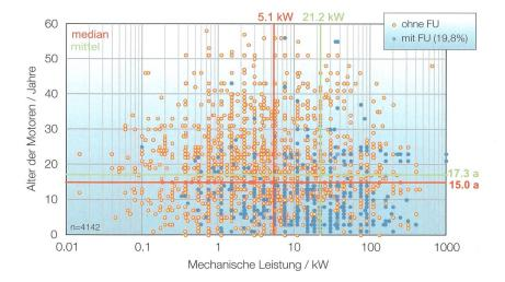
**Bild 5** Anteil Frequenzumrichter geregelter Motoren.
