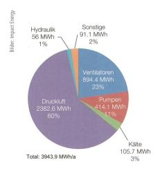
**Bild 9** Einsparungen nach Anwendungen im Förderprogramm Easy.
