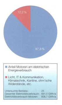
**Bild 3** Anteil Elektrizitätsverbrauch von Motoren in der Industrie.
