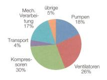
**Bild 6** Elektrischer Verbrauchsanteil der verschiedenen Anwendungen.
