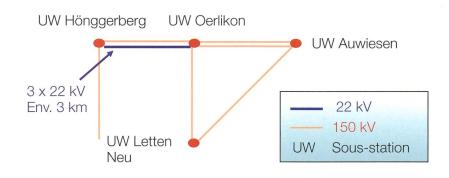
Figure 1 La ligne MT faisant l'objet de l'étude entre les sous-stations Oerlikon et Hönggerberg.
