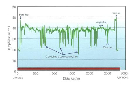
**Figure 3** Profil de la température de gaine mesurée sur la ligne MT reliant les deux sous-stations Oerlikon et Hönggerberg.
