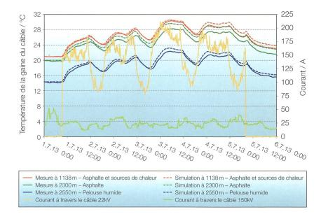
**Figure 5** Comparaison entre la température de gaine mesurée et simulée à trois emplacements correspondant à différentes configurations de l'environnement (du 1<sup>er</sup> au 6 juillet 2013).
