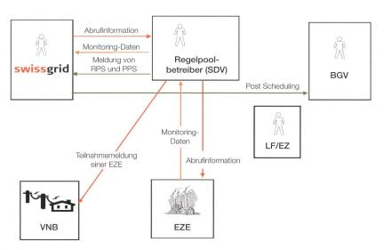
**Bild 1** Prinzip von Demand Response – Aggregation von Flexibilitätsbausteinen zur Vermarktung an Energiemärkten.
