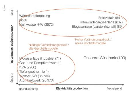
**Bild 2** Energieproduktionstechnologien und Veränderungsdruck<sup>2</sup> auf die Systemarchitektur sowie deren Verbreitung (in GWh) in der Schweiz 2014.[4]
