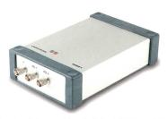
Die abgleichende Messbrücke MBB1 wird für TE-Messungen und -Analysen eingesetzt.
