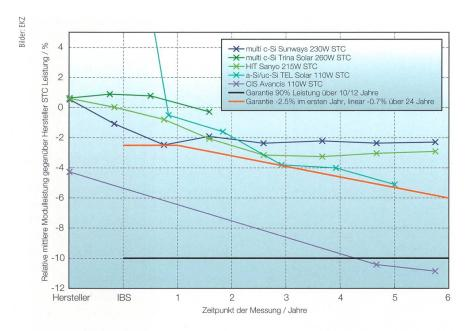
**Bild 2** Mittlere gemessene Modulleistungen unter Standard-Testbedingungen STC in Abhängigkeit der Anzahl Jahre nach Inbetriebsetzung (IBS). Die rote Garantiekurve gilt für die Module von Trina Solar, die schwarze für die Module von Sunways, Sanyo, TEL Solar und Avancis.
