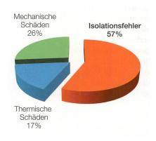
**Bild 1** Verteilung von Schadensursachen bei Hydrogeneratoren. [1]
