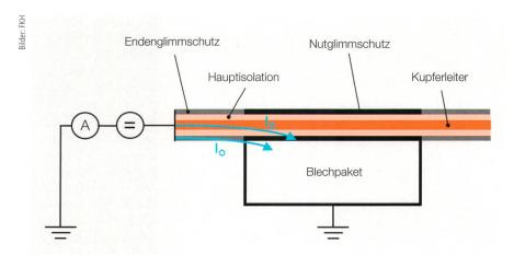
**Bild 5** Der Leckstrom in der Isolation ist die Summe des Oberflächenstroms  $I_0$  und des Leitungsstroms  $I_n$ .
