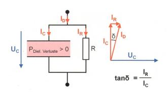
**Bild 3** Ersatzschaltbild der Isolation und Definition des Verlustfaktors ( $\tan \delta$ ).
