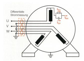
**Bild 4** Online-Verlustfaktormessung mittels Differenz-strommessung.
