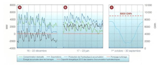
**Figure 4** Corrélation entre la consommation résiduelle et la production hydraulique à accumulation. Exemple de l'année 2013 : semaine du 16 au 22 décembre (a), semaine du 17 au 23 juin (b). Variation de l'énergie accumulée dans les barrages sur l'ensemble de l'année 2013 (c).
