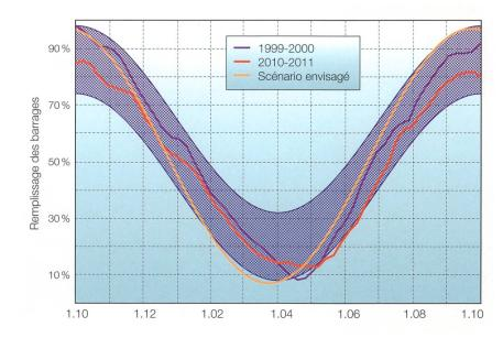
**Figure 3** Contenu énergétique des bassins d'accumulation au cours des années hydrologiques 1999-2000 et 2010-2011. La bande bleue indique qualitativement les niveaux historiques minimaux et maximaux. La courbe jaune propose un turbinage plus intensif en hiver et moins intensif en été.
