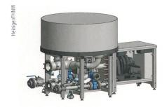
Darstellung des industrietauglichen Prototypen des thermomagnetischen Motors. Das Herzstück der Maschine ist im Betrieb unter einer Kunststoffabschirmung verborgen.
