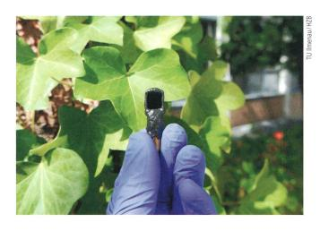
Die Rekordzelle für direkte solare Wasserstofferzeugung mit 14 % Effizienz.
