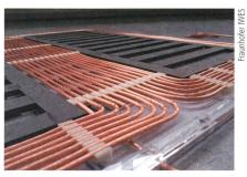
Spulensystem zum induktiven Laden von E-Fahrzeugen.
