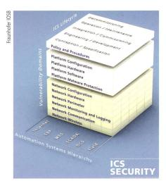
**Bild 2** Sicherheitsmodell für Produktionsanlagen.
