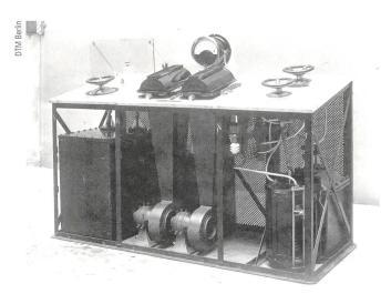
**Bild 2** Sender der Grossstation mit 16-teiliger Löschfunkenstrecke vor dem Antennenstrommesser (1913).
