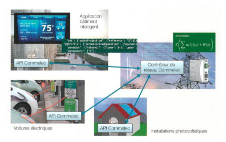
**Figure 5** L'interface de programmation (API) de Commelec permet de connecter simplement un système de gestion de bâtiment, de batterie ou de station de recharge de véhicules électriques; tous ces systèmes peuvent alors apporter leur contribution active à la gestion des réseaux électriques.
