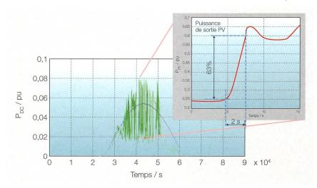
**Figure 1** Variabilité de la production des panneaux solaires photovoltaïques (mesurée sur les toits de l'EPFL, un jour de novembre). La production peut chuter des 2/3 ou augmenter du triple en l'espace de 2 secondes.
