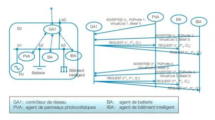
Figure 3 Structure et principe du protocole Commelec.
