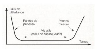
**Figure 1** Taux de défaillance des systèmes électriques.
