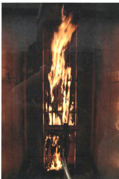
Figure 3 Essai au feu comme utilisé pour la classification décrite (Reaction to Fire). À gauche un câble avec un faible niveau de sécurité, à droite un câble avec un niveau de sécurité élevé.
