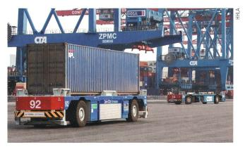
**Bild 2** Batterieelektrisch angetriebenes AGV beim Containertransport im Container Terminal Altenwerder.
