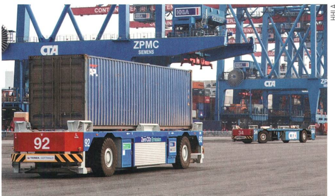
Bild 2 Batterie-elektrisch angetriebenes AGV beim Containertransport im Container Terminal Altenwerder.
