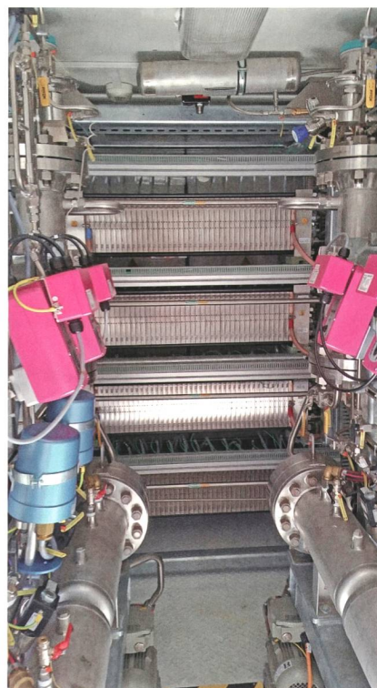
Bild 3 Im Hintergrund die PE-Stacks des Elektrolyseurs, vorne die Gas- und Wasseraufbereitung.
