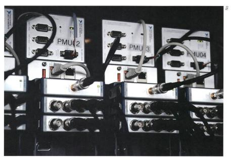
Die Erfassung des Netzzustands ist im Smart Grid zentral. An der ETH Lausanne werden dafür Phasor Measuring Units, die mit GPS synchronisiert werden, entwickelt und eingesetzt.
