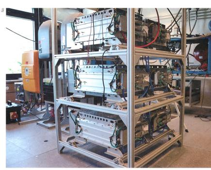
Super-Kondensatoren statt Schwungmasse: Am Microgrid-Labor der ETH Lausanne werden für die kurzzeitige, schnelle Speicherung von Strom Supercaps (75 kW, 1 kWh) eingesetzt.
