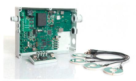
Bild 2 Das Gridbox-Basismodul, ein Strommodul und vier Stromsensoren.
