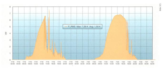
Bild 5 PV-Einspeisung eines Hausanschlusses.
