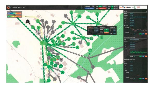
**Bild 4** Live-Messwerte können im Sekundentakt überwacht und angezeigt werden.
