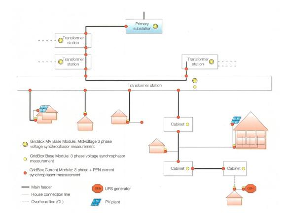
**Bild 1** Schematisches Gridbox-Pilotnetz.
