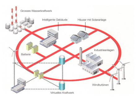
**Bild 1** In Smart Grids werden verschiedene Technologien integriert und ermöglichen neue Funktionalitäten der Stromnetze. Das Bild zeigt das Zusammenspiel einiger Technologien (vgl. hierzu European Technology Plattform, www.smartqrids.eu).
