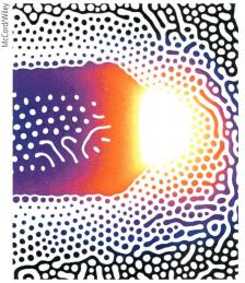
Thermografische Aufnahme eines integrierten Schaltkreises mittels pyro-magnetischer Optik. Das Bild zeigt sowohl die magnetischen Domänen als auch die Wärmeverteilung entlang der Drähte an.
