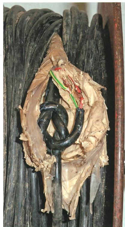
Fehlerhafte Arbeiten an elektrischen Installationen und Geräten durch Laien können tödlich sein – Kabelrolle unter Spannung.
