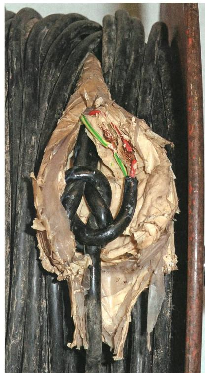
Lavori difettosi su impianti e apparecchi elettrici eseguiti da persone non qualificate possono essere letali – Rotolo di cavo sotto tensione.
