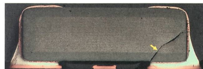
Bild 2 Bruchstelle in einem Keramik-Kondensator (Schliffbild). Der Bruch ist von oben durch die Lötkepappe verdeckt und durch Inspektionen nicht erkennbar. Häufig entstehen nur winzige Risse, die erst nach längerer Zeit zu Kurzschlüssen führen.
