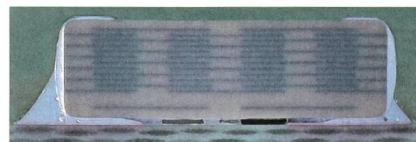
Bild 3 Innerer Aufbau eines kurzschlussfesten Keramik-Kondensators.
