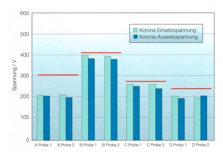
**Bild 4** Koronaeinsetz- und Aussetzschwellen verschiedener Kondensatorproben. Die rote Linie zeigt jeweils die vom Kondensatorhersteller angegebene AC-Nennspannung.
