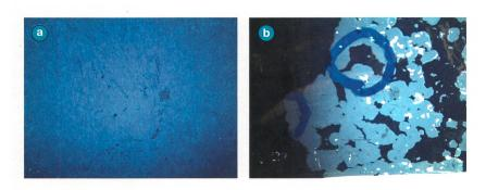
**Bild 5** Betrachtung von abgewickelter Kondensatorfolie unter einem Mikroskop (Unterlicht). Links neuer Kondensator; rechts Kondensator nach Langzeiteinsatz, Zone mit Lufteinschluss; zahlreiche Delaminationen (dunkel: beide Seiten metallisiert, hellblau: eine Seite metallisiert, weiss: keine Metallisierung mehr vorhanden).
