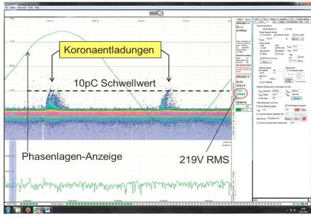
**Bild 3** Beispiel einer Koronaentladungsmessung im Folienkondensator.
