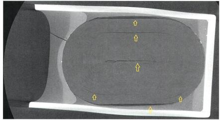
**Bild 1** Virtueller Mikroschnitt mittels Röntgen-Tomografie durch einen Folienkondensator. Die gelben Pfeile zeigen Lufteinschlüsse; zusätzlich ist links ein Riss in der Gehäuse-Vergussmasse erkennbar.
