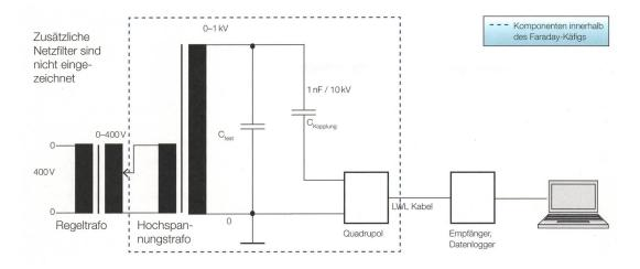
**Bild 2** Grundsätzlicher Messaufbau zur Korona-Entladungs-Messung in Folienkondensatoren.
