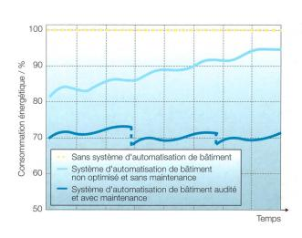
Figure 3 Impact sur la consommation énergétique d'un bâtiment d'un système audité et optimisé en cours d'exploitation.
