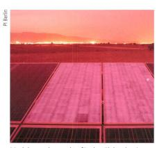
Module werden nachts für den Elektrolumineszenz-Test bestromt.
