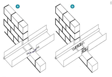
**Bild 7** Durchführung metallener Kanäle in Brandschottungen (Fig. 4.4.4.Z1.1.2).
