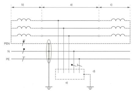
**Bild 2** TN- und TT-Mehrfacheinspeisung mit einer Verbindung PEN und PE (Fig. 4.4.4.4.6.1.1). a) Anlage, b) Stromquelle 1, c) Stromquelle 2, d) Erdung im TT-System, e) Körper.
