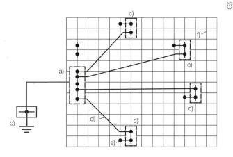
**Bild 3** Beispiel einer vermaschten Potenzialausgleichsanlage mit einem sternförmigen Netz
