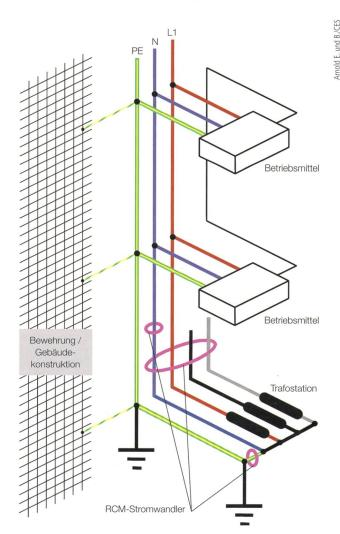
Bild 1 Prinzipdarstellung Netzstruktur TN-S-System (in Anlehnung an Fig. 4.4.4.3.2.1) mit Darstellung von Möglichkeiten der Integration von Differenzstrom-Überwachungsgeräten (RCM-Stromwandlern).
