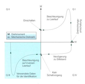
Bild 2 Drehmoment-Drehzahl-Ebene.
