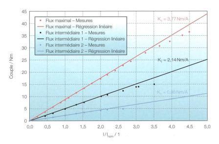
Figure 6 Couple mesuré en fonction du courant pour différents niveaux de magnétisation.
