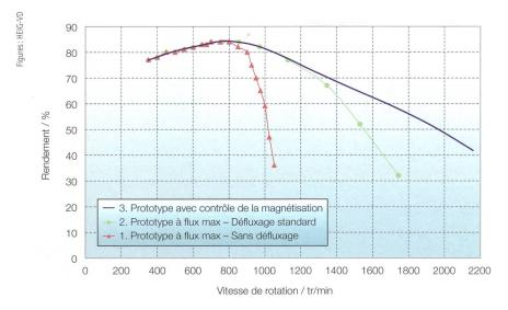
**Figure 11** Rendement pour les points de fonctionnement mesurés dans le cas d'un défluxage standard et dans le cas d'une modification de la magnétisation des aimants AlNiCo ( $U_{DC} = 450 \text{ V}$ ).
