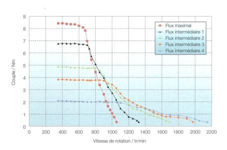
**Figure 9** Caractéristiques « couple-vitesse » mesurées pour différents niveaux de magnétisation.
