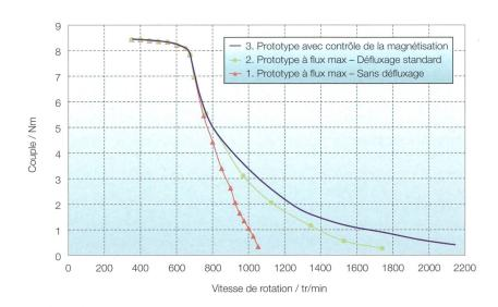
**Figure 10** Comparaison des graphiques « couple-vitesse » dans le cas d'un défluxage standard et dans le cas d'un contrôle de la magnétisation des aimants AlNiCo ( $U_{DC} = 450 \text{ V}$ ).
