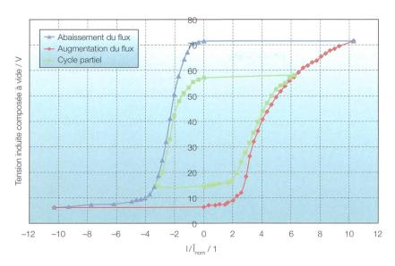
**Figure 7** Abaissement et augmentation du flux, cycle complet et cycle partiel. Tension induite de mouvement mesurée à 300 tr/min.
