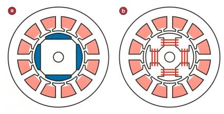
Figure 1 Moteurs synchrones (a) à aimants permanents et (b) à rotor bobiné.
