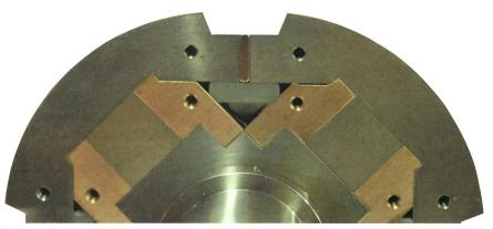
Figure 4 Rotor du prototype réalisé : vue de face.
