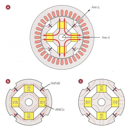
**Figure 3** Principe de fonctionnement: (a) Flux magnétisant ou démagnétisant les aimants AlNiCo (axe d); (b) Rotor avec flux minimal généré dans le stator; (c) Rotor avec flux maximal généré dans le stator.
