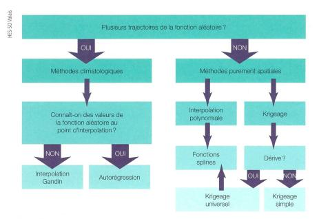
Figure 2 Approche des méthodes d'interpolation (d'après Laborde 2000 [13]).
