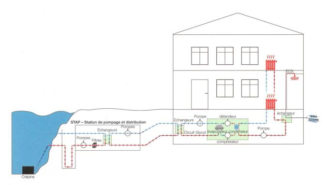
Figure 2 Deux circuits d'eau et des pompes à chaleur individuelles permettent d'utiliser l'eau du lac comme source de chaleur.
