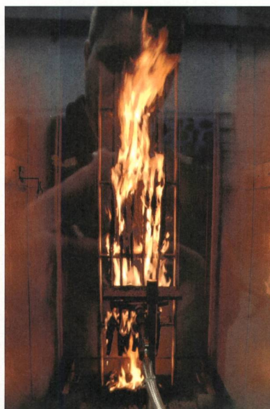
Bild 3 Brandtest, wie er für die beschriebene Klassifizierung (Reaction to Fire) verwendet wird. Links ein Kabel mit niedrigem Sicherheitsniveau, rechts eines mit hohem Sicherheitsniveau.
