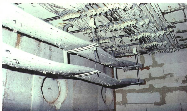
Bild 4 Vor (oben) und nach einer Prüfung. Nur die Prüfung des Funktionserhalts ermöglicht einen Rückschluss auf die Funktionstüchtigkeit im Brandfall.
