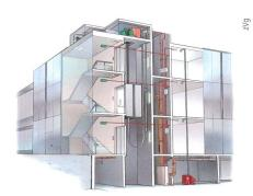
**Bild 5** Gebäude benötigen Funktionserhalt für z.B. Notbeleuchtung, Sprinkler- und Rauchabzugsanlagen sowie Alarmierungseinrichtungen.
