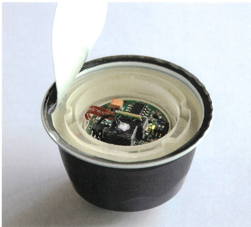
Das Sensorsystem sendet die Daten des Restsauerstoffgehalts in Echtzeit und ermöglicht so schnelle Optimierungen einer Produktionsanlage.
