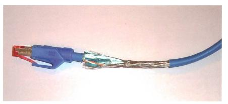
Figure 2 Exemple de câble blindé.
