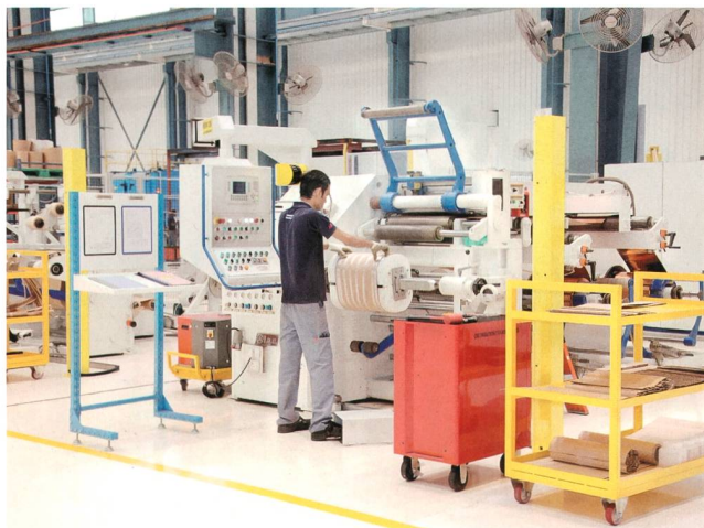
Wicklungsprozess für ölgekühlte Transformatoren.
