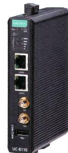
Der UC-8100 arbeitet mit einer Spannung von 12 bis 24 V. Standardversion-Betriebstemperatur: -10 bis 60 °C.
